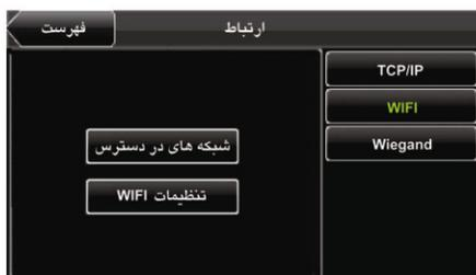
پیش از استفاده از گزینه WIFI به عنوان شیوه ارتباط، سایر اجزاء شبکه ۱۱.۰۲.۸۰ از قبیل سیستم توزیع شبکه و Joint ها باید مشخص و آماده استفاده باشند. برای اتصال به شبکه SSID و یا ESSID شبکه مورد نظر نیز باید مشخص باشد. برای انجام تنظیمات شبکه بی سیم،
