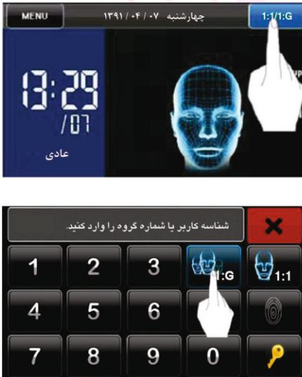
همچنین در صورت اختصاص یکی از کلیدهای صفحه کلید به گزینه **1:1/1:G** می توان از صفحه کلید یا کلیدهای متناظر آن روی صفحه نمایش نیز استفاده کرد. در صورت تمایل به استفاده از تشخیص چهره 1:G ابتدا باید گروه ها و پرسنل متعلق به هر گروه در بخش تعریف کاربر مشخص شوند.
