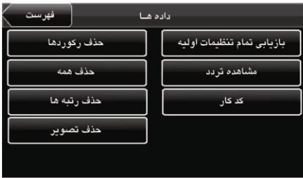
مدیریت داده های دستگاه از جمله پاک کردن رکوردهای دستگاه، پاک کردن کلیه اطلاعات موجود در دستگاه (شامل پرسنل تعریف شده)، تغییر رتبه مدیر به کاربر، پاک کردن تصاویر تبلیغاتی، بازیابی تنظیمات اولیه دستگاه، مشاهده تردد، تعریف کد کار.
