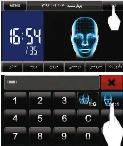
همچنین در صورت اختصاص یکی از کلیدهای صفحه کلید به گزینه 1:1 می توان از صفحه کلید یا کلیدهای متناظر آن روی صفحه نمایش نیز استفاده کرد. اگر تا ۲۰ ثانیه چهره ای تشخیص داده نشود، دستگاه به صفحه اولیه برمی گردد.
